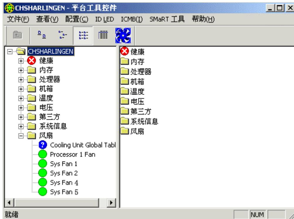
如果安装或重新安装了风扇，PIC 可将警告发送到管理控制台，刷新 PIC 接口，并报告新安装的风扇（如下所示）。
