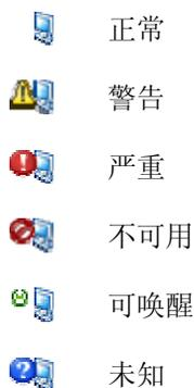
ISM 通过监视关键的操作功能（例如，可用硬盘空间、可用内存、温度及电压）来确定计算机的健全性。当发生健全性事件（例如磁盘空间不足）时，健全性状况会发生改变以反映事件的严重程度。警报向您警告事件。通知日志将跟踪来自 ISM 的通知。这种预警系统可以通知您及早进行必需的维护任务。
