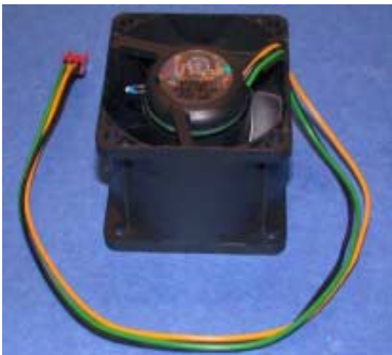
Рисунок 1. Вентилятор диаметром 38 мм, требующий ток в 1,5А
